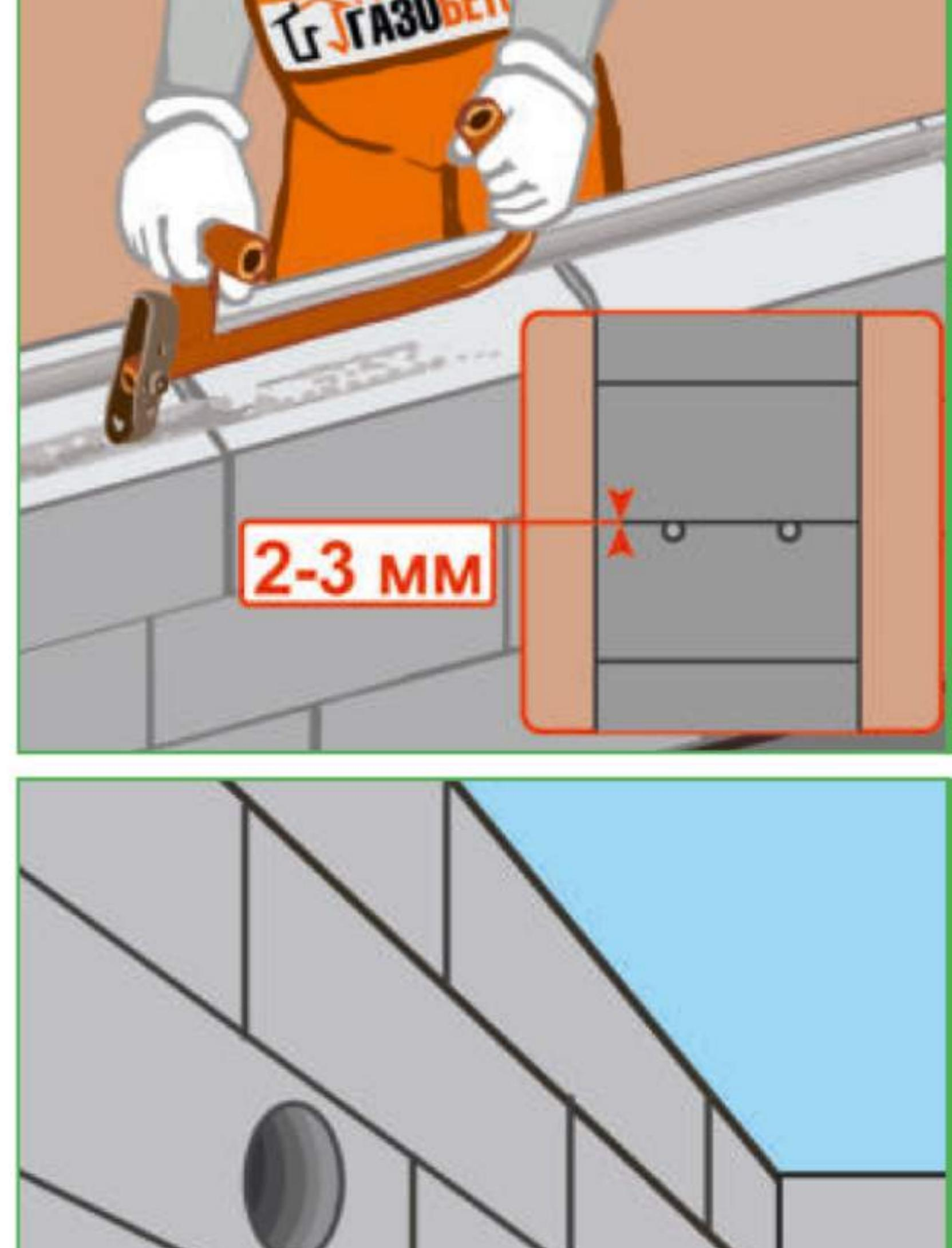
**Штроборез** применяется для вырезания пазов под электропроводку, арматуру или трубу небольшого диаметра
